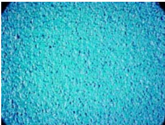
Bild 12: grob strukturierte Lackoberfläche
